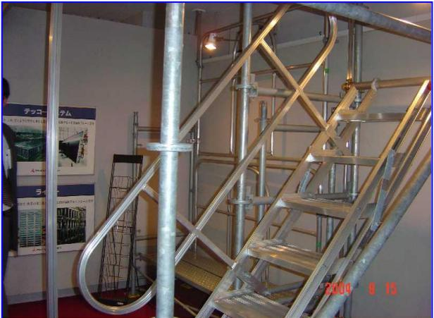
照片 2：上下設備樓梯應有適當護欄（得採足以防護工作者墜落之上拉桿等設備固定於上端交叉拉桿扣釘之方式代替）。
